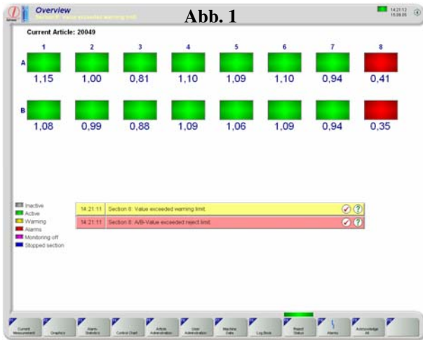
Bildschirmübersicht mit Anzeige von Alarm-/Warnmeldungen und aktuellem, in Zahlen ausgedrücktem Formdruck
