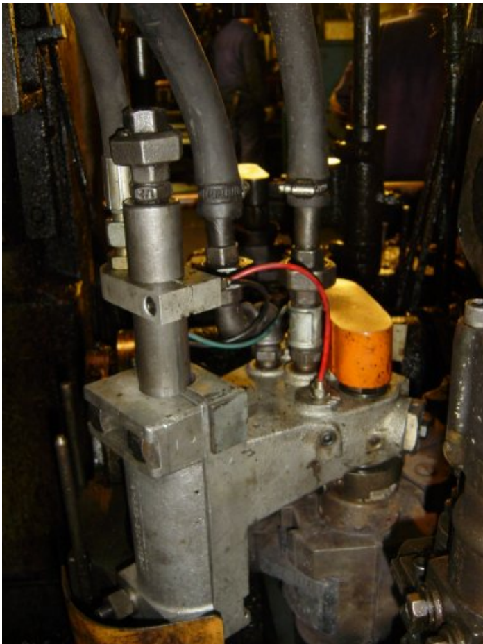
Typische Druckmesspunkte einzelner Formen an einem Standard-Blaskopfarm
